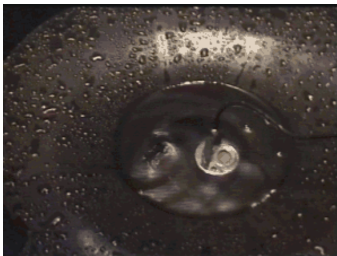
Figuur 24: Als de mistgenerator niet actief is, kan de vortex op het wateroppervlak toch gezien worden, door een wervel op het wateroppervlak. Deze foto demonstreert ook de noodzaak van een gewelfde onderste plexiglas plaat om het spatwater te laten terugvloeien naar het waterbasin. Er is een boel spatwater dat rondvliegt in de machine.
