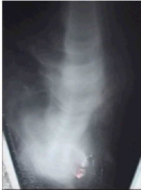
Figuur 23: De vortex met de generator op vol vermogen. De vortex (of de mistgenerator) moet iets uit het midden worden geplaatst, zodat de mist niet direct in de kern van de vortex terechtkomt en te snel verdwijnt naar boven. Als de mist aan de zijkant van de vortex opgezogen wordt wordt de vortex breder, en ziet U de gelaagde structuur van de vortex goed.
